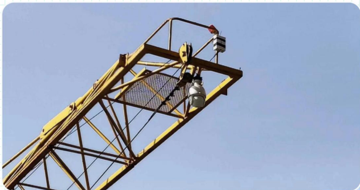
塔式起重机加装吊钩可视化系统
